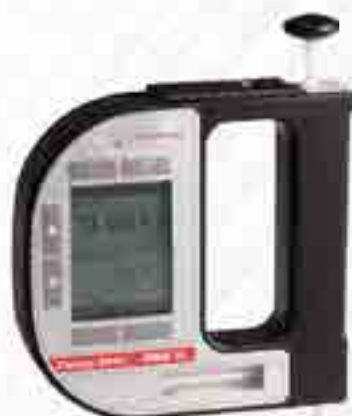
Calibración de Densímetros Digitales, en un intervalo de medida de 1\,125,6 \text{ kg/m}^3
