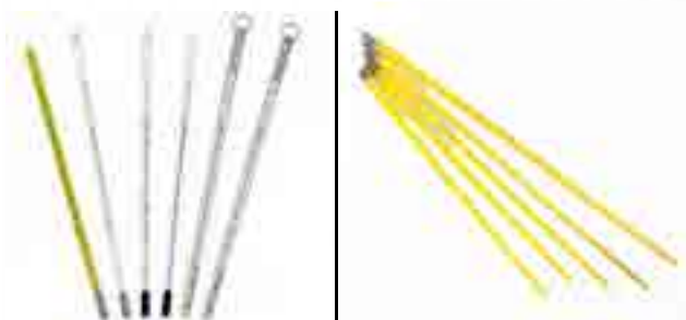
Termómetros de líquido en vidrio Alcance: -20 °C a 120 °C
